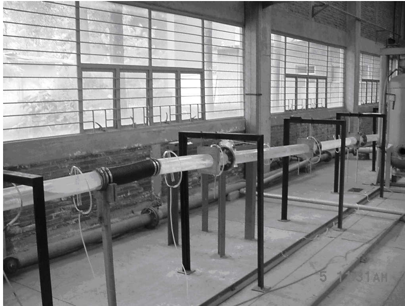
Figura 3.5 Sección de medición del dispositivo experimental aguas abajo
