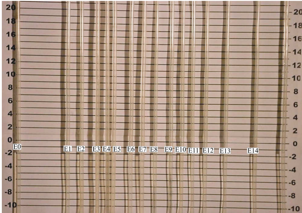
Figura 4.3 Tablero de manómetros
