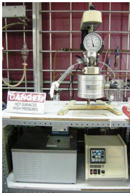
Figura 9. Reactor por lotes para la evaluación de actividad catalítica.
