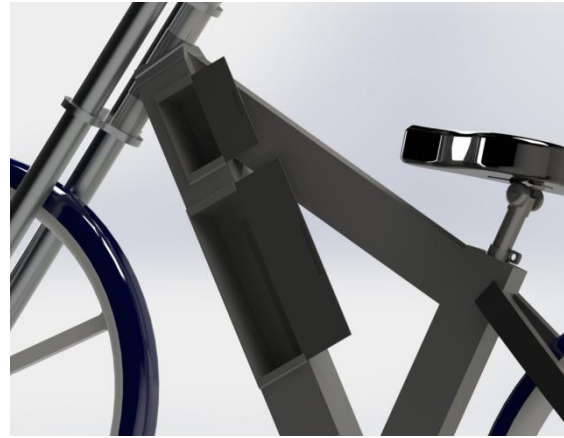
5.11 Espacio para los componentes eléctricos
