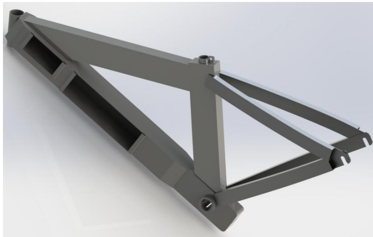
Figura 5.9 Cuadro Para Bicicleta Eléctrica (CPBE)
