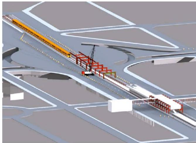
**Fig. 55 Montaje de travesas longitudinales.**
