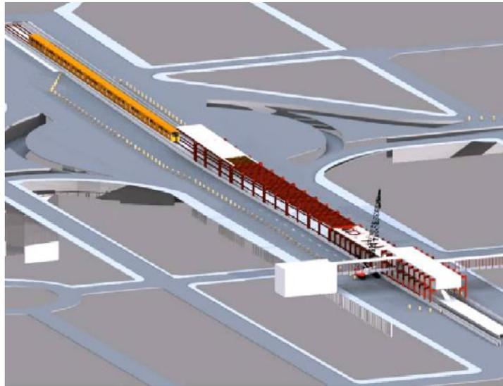
**Fig. 57 Colocación de sistema de entripiso.**
