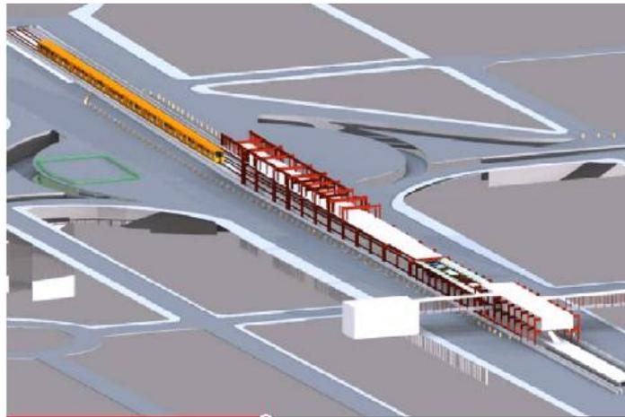
**Fig. 59 Montaje de travesas longitudinales a nivel azotea.**
