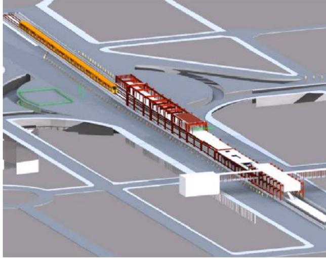
**Fig. 60 Montaje de travesas a nivel azotea**
