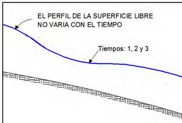
Figura 39. Flujo permanente. Imagen tomada de: Referencia bibliográfica No. 9
