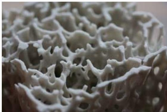
Figura 5. Andamio obtenido por medio de tecnología CAD-CAM.<sup>16</sup>
