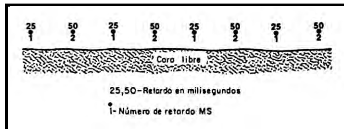
Figura 5.51 Primera fila de barrenos con periodos alternados.
