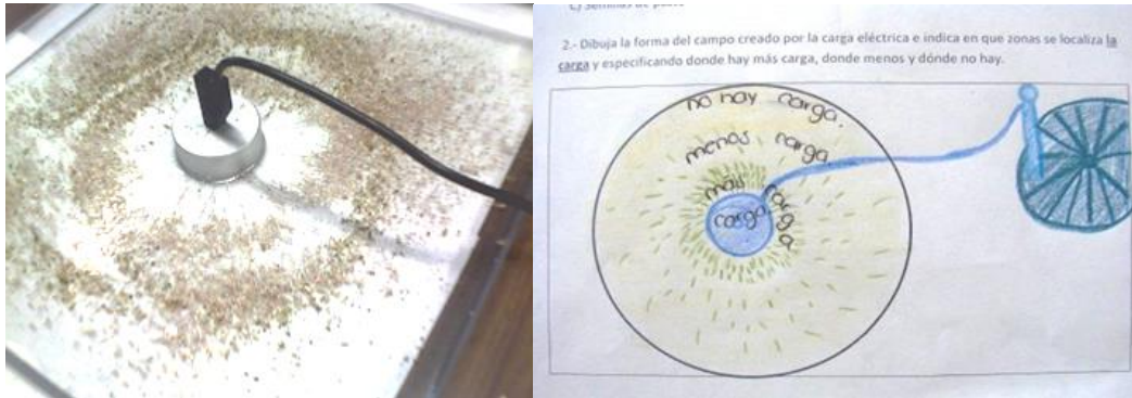
Ilustración 17: Fotografía del experimento y dibujo realizado por un alumno que representan la distribución de semillas de té en aceite debida al campo electrostático en el conductor central. Debe destacarse la distribución de carga según el alumno.
