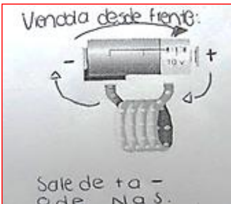
Ilustración 32: Ejemplo en que los polos del campo magnético se han asociado a la pila y no al solenoide.
