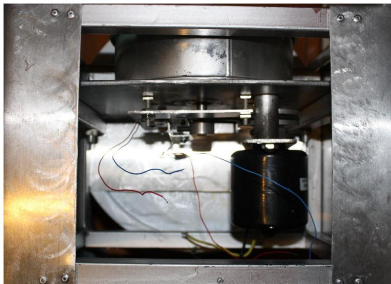
Figura 74 Fotografía del ecanismo usado en el Spin Coater
