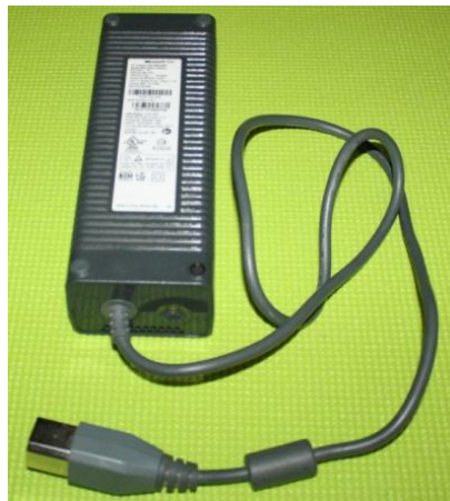
Figura 65 Fuente de alimentación de un Xbox 360 utilizada para alimentar al Spin Coater
