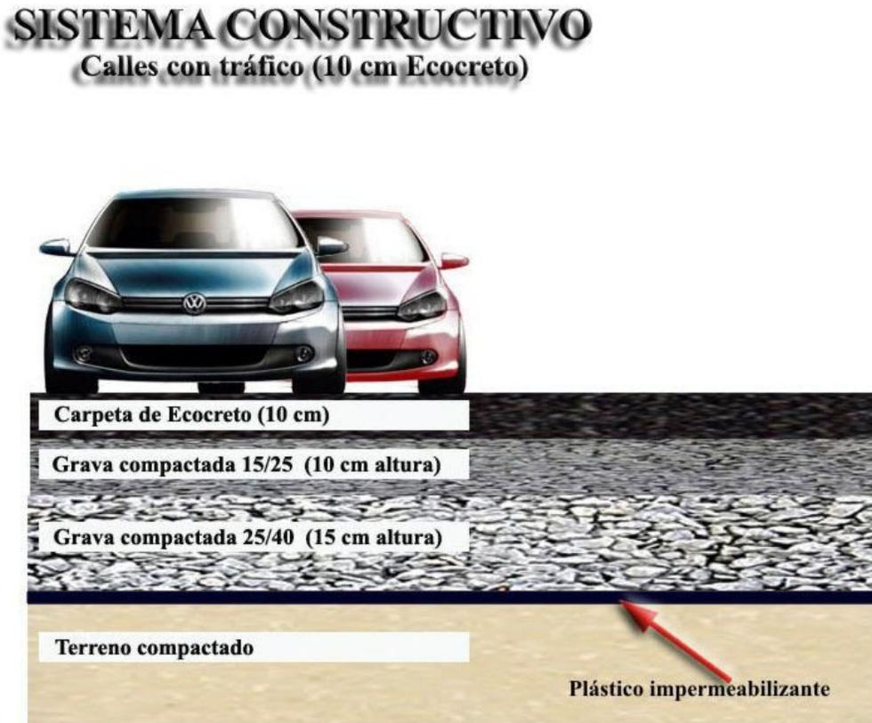
**Figura 3.22. Sistema constructivo recomendado para pavimentos con tráfico vehicular.**
