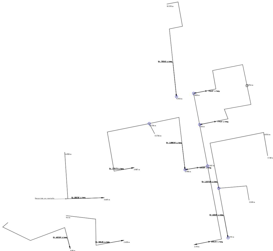
**Figura 3.21.** Flujo de aportaciones del sistema delimitado por zonas de control a base de concreto permeable.
