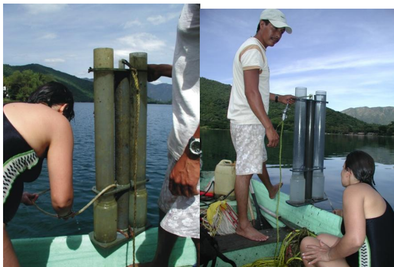
Fig. 14. Trampas de sedimento del lago, a la izquierda se muestra la trampa que fue colocada en la parte litoral y a la derecha la recuperada en la zona central.
