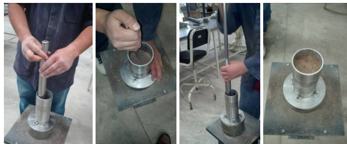
Figura 4.23. Proceso de compactación.
