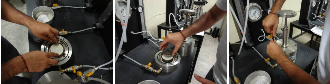
Figura 4.44. Colocación de papel filtro y ensamble de la celda de presión.
