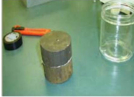
Figura 2.4. Determinación de la succión mátrica del suelo utilizando el método de contacto por medio de papel filtro (Bulut et al., 2001; tomada de Pola, 2010).
