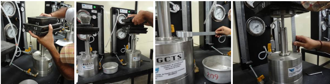
Figura 4.45. Colocación de pesos en la placa de carga y toma de lecturas iniciales.
