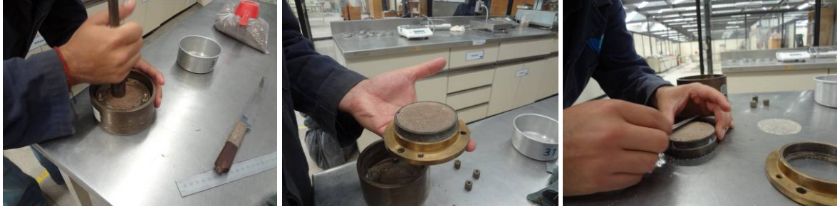
Figura 4.42. Preparación del espécimen de prueba para la determinación de la curva característica.
