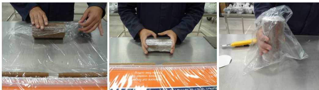
Figura 4.26. Empaque de especímenes compactados.
