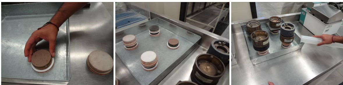
Figura 4.43. Proceso de saturación del espécimen de prueba.
