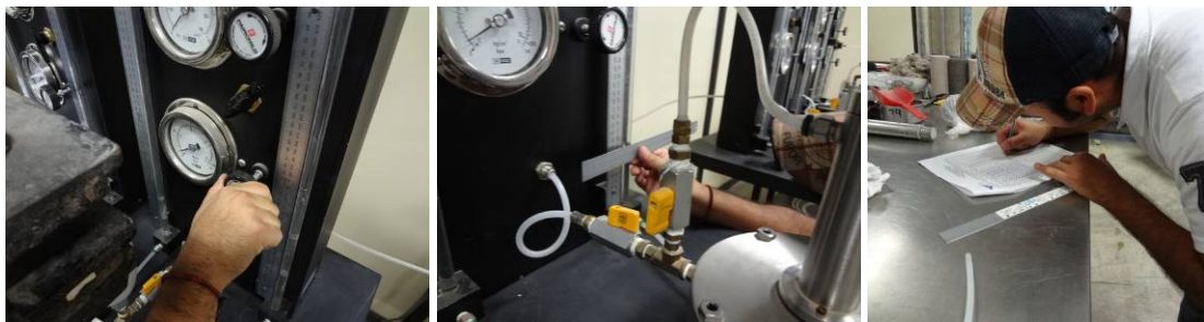
Figura 4.46. Incremento de presiones y toma de lecturas durante la ejecución de la prueba.
