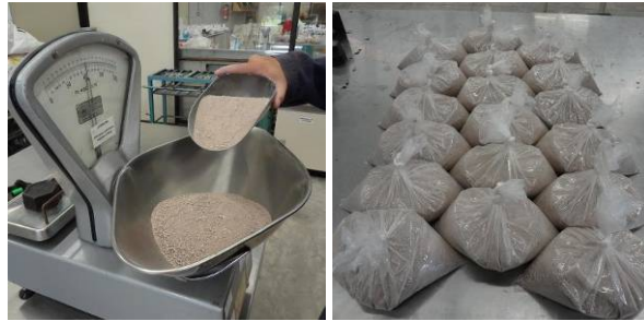
Figura 4.17. Dosificación de materiales.
