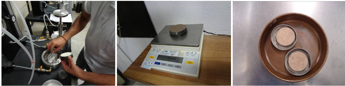
Figura 4.47. Desensamble de la celda de presión y determinación del contenido de agua final.
