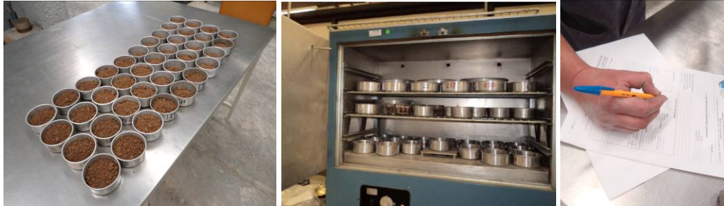
Figura 4.27. Verificación de las condiciones de compactación.
