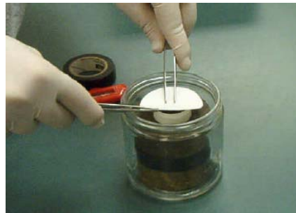
Figura 2.3. Determinación de la succión total del suelo utilizando el método sin contacto por medio de papel filtro (Bulut et al., 2001; tomada de Pola, 2010).
