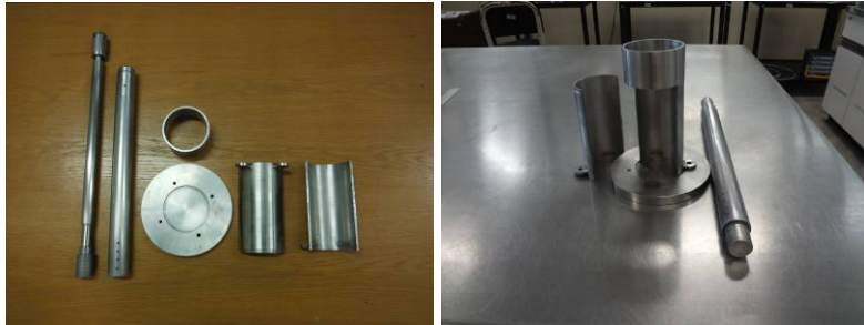
Figura 4.19. Equipo de compactación para la fabricación de los especímenes de prueba.
