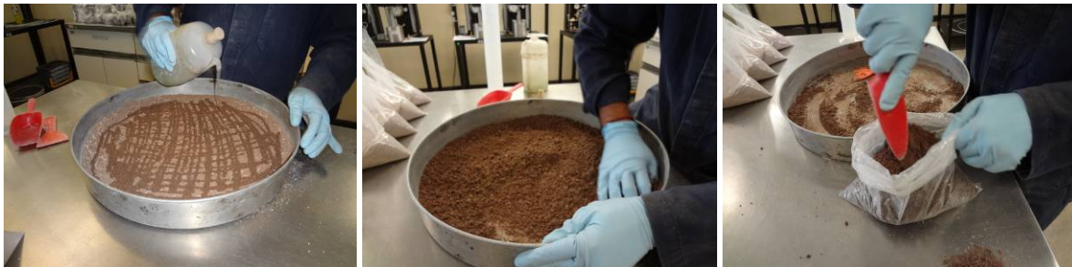
Figura 4.18. Proceso de humectación, mezclado y curado de muestras.
