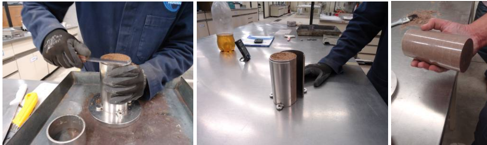
Figura 4.24. Enrase y extracción del espécimen de prueba.
