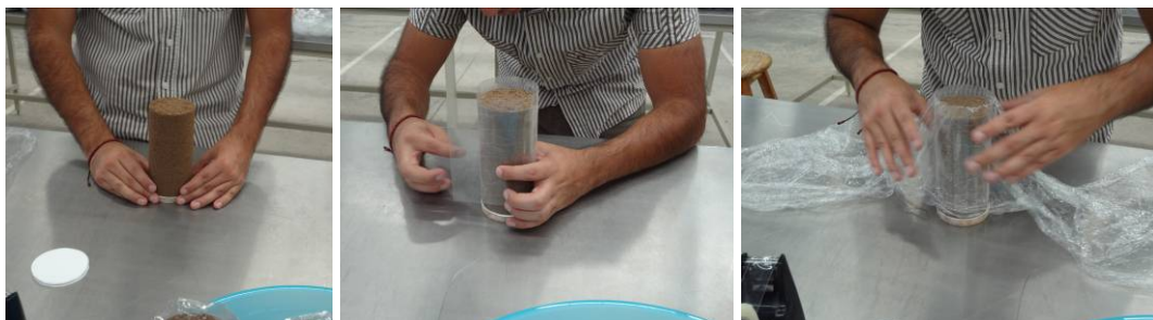
Figura 4.29. Preparación de especímenes para el proceso de humedecimiento.
