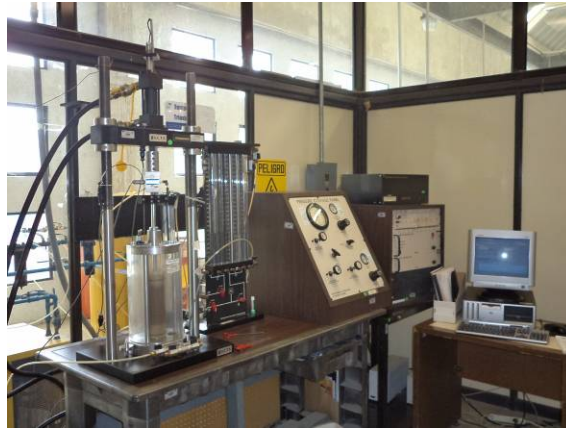
Figura 4.1. Unidades que componen el equipo triaxial cíclico.
