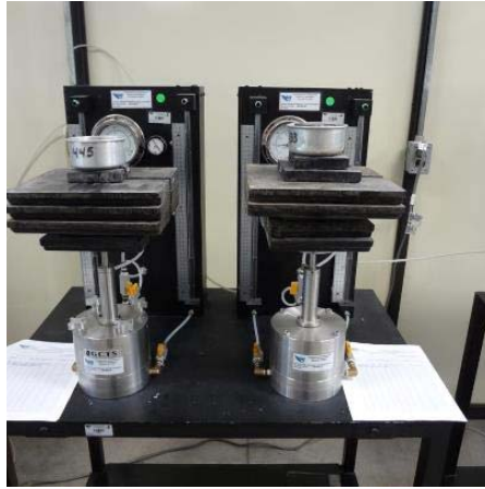
Figura 4.9. Dispositivos de Fredlund para la determinación de la curva característica.
