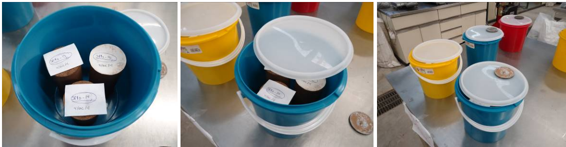
Figura 4.28. Acondicionamiento de especímenes (trayectoria de secado).
