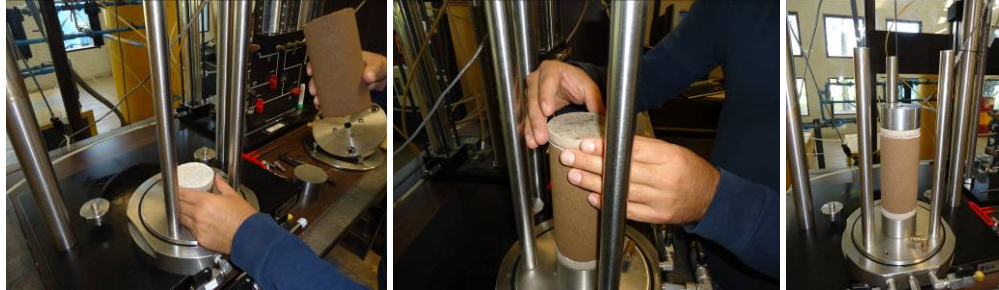
Figura 4.31. Colocación de piedras porosas y papel filtro.
