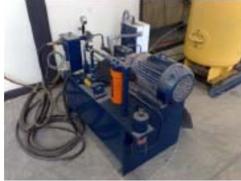
Figura 4.4. Sistema hidráulico para la aplicación de cargas.
