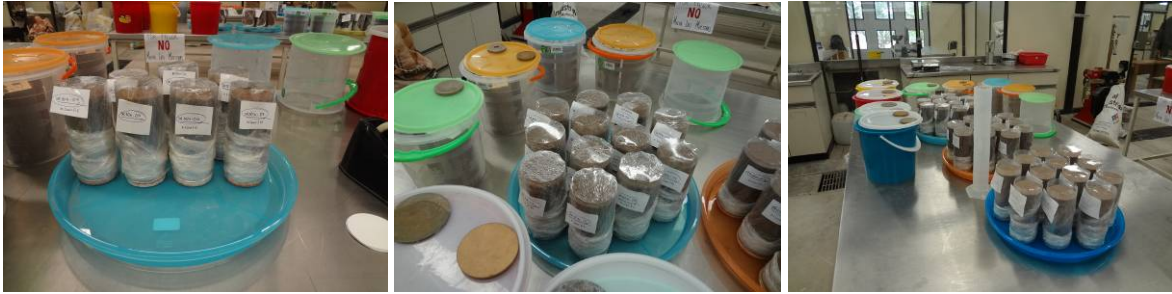
Figura 4.30. Acondicionamiento de especímenes (trayectoria de humedecimiento).
