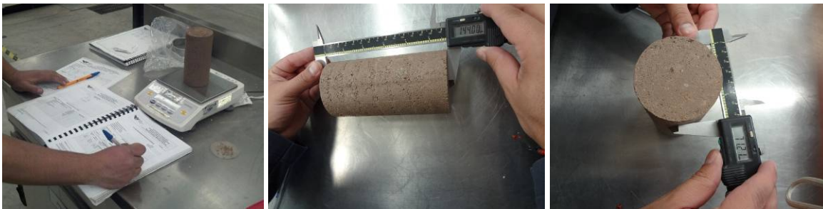
Figura 4.25. Pesaje y medición del espécimen compactado.
