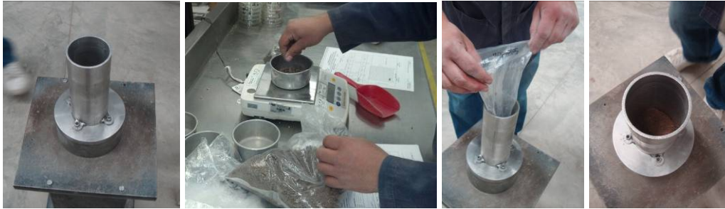
Figura 4.21. Pesaje y colocación del suelo en el molde de compactación.
