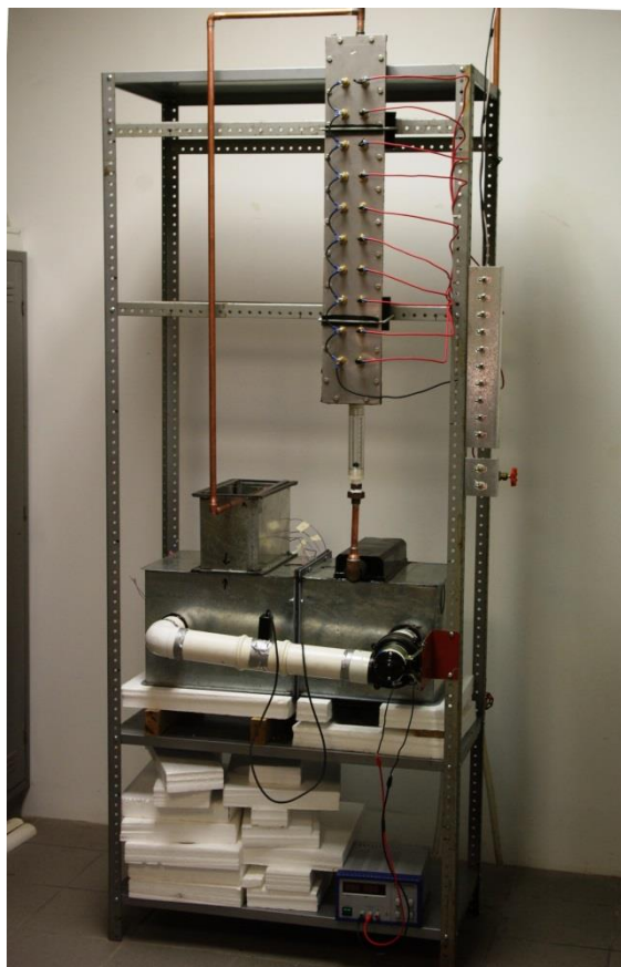
Figura A-VIII.5. La primera versión del sistema completo armado en su estructura, pero aún sin aislante térmico.
