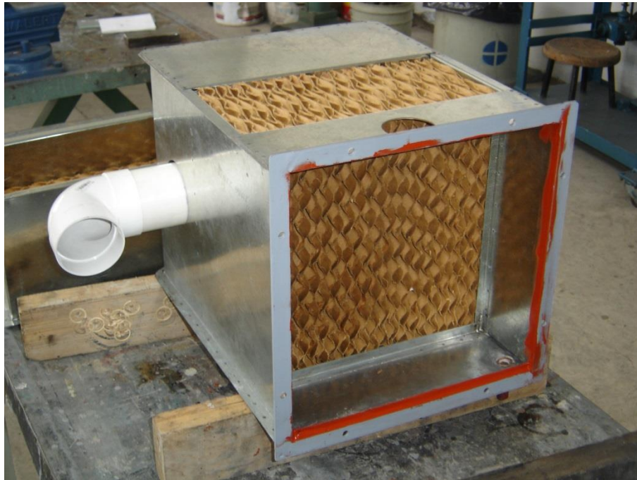
Figura A-VIII.2. El relleno de Friocel dentro del evaporador.
