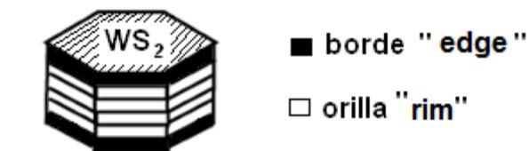
Figura 4.31 Esquema de un cristal de  $WS_2$ .
