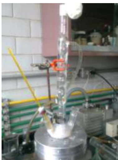
Figura 2.2 Equipo experimental para la reacción de derivatización sólido – líquido a presión atmosférica.
