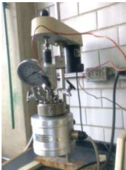
Figura 2.3 Equipo experimental para la reacción de derivatización sólido – líquido a 14.6 atm de presión.
