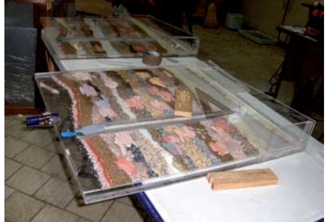
Fig.13 Sujeción de los contenedores después del pegado de sus caras laterales.
