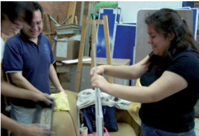
Fig.11 Vaciado de las piedras y arenas que conforman los estratos.
