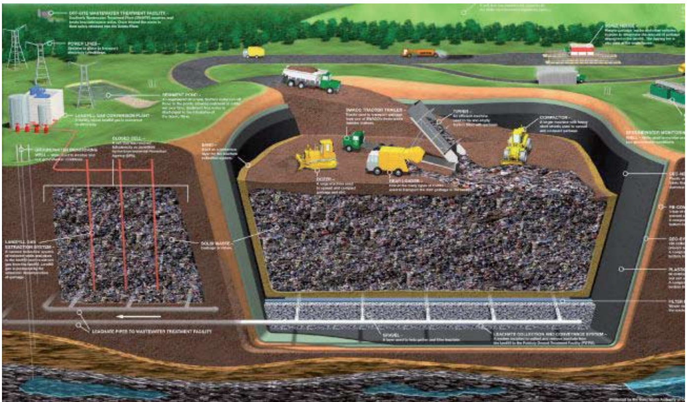
Fig.3 Esquema de funcionamiento de un relleno Sanitario. Fuente: http://www.dforceblog.com
