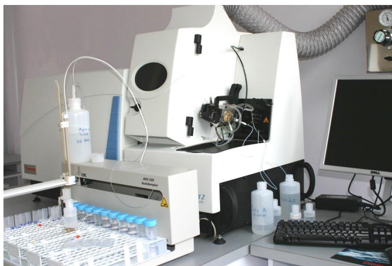
Figura 8. Equipo ICP-MS del Laboratorio de Geoquímica del Instituto de Geología de la UASLP.
