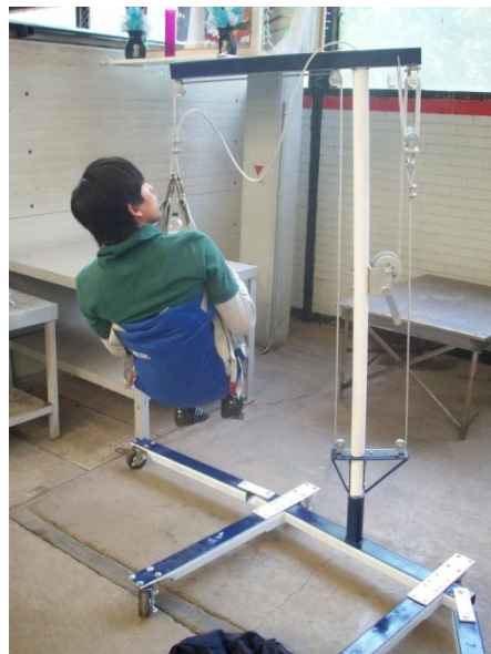
Figura 6.3 y 6.4 Pruebas con persona de 80 kg.
