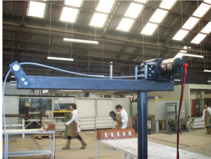
Figura 7.4 Malacate eléctrico montado en el prototipo 2.
