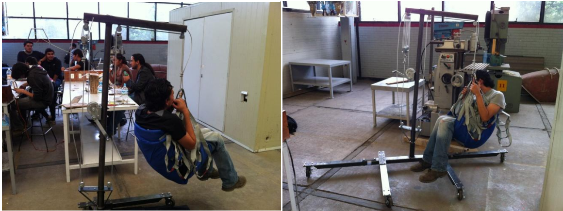
Figura 6.3 y 6.4 Pruebas con persona de 80 kg.
