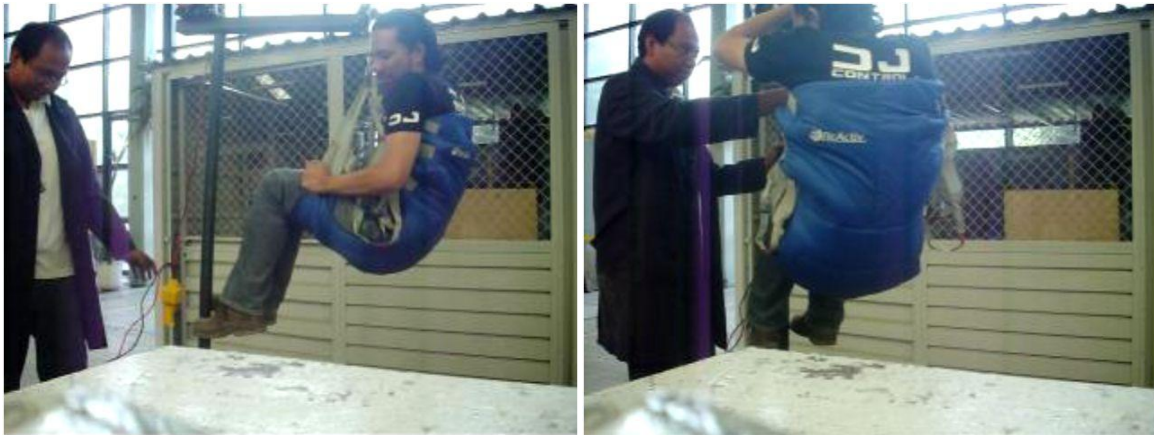
Figura 7.5 y 7.6 Prueba del prototipo 2 con persona de 80 kg.
