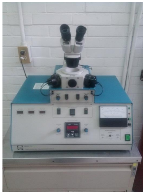
Figura 24. Desbastador iónico PRECISION ION POLISHING SYSTEM, marca GATAN modelo 691.
