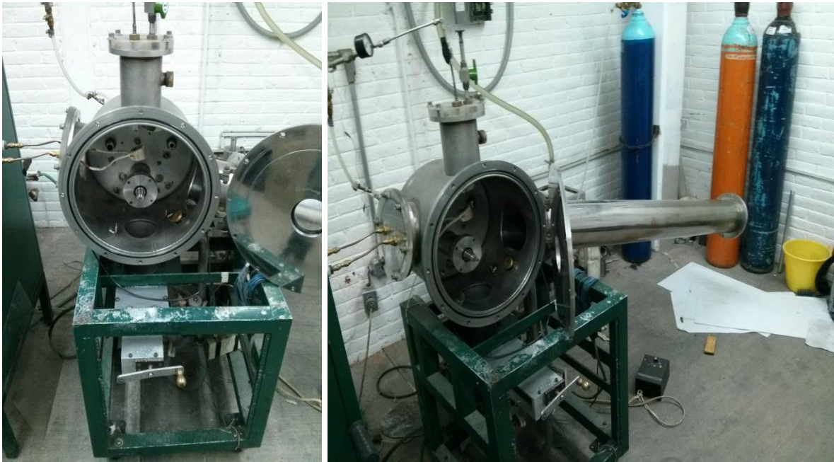
Figura 15. Dispositivo Melt-Spinning utilizado para la fabricación de las cintas metálicas.
