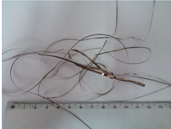
Figura 28. Cinta metálica obtenida mediante la técnica de melt-spinning.
