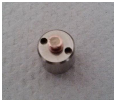
Figura 23. Muestra colocada en la rejilla antes de ser sometida al desbastador iónico.
