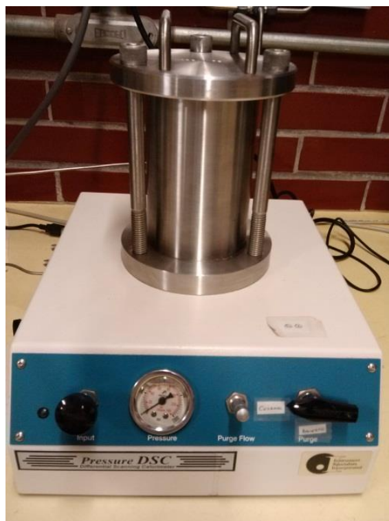
Figura 16. Equipo utilizado (Pressure DSC) durante el análisis térmico.
