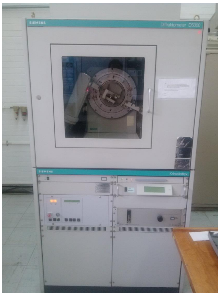
Figura 18. Diffractometer D5000 marca SIEMENS con lámpara de Cobalto utilizado durante el análisis de DRX.
