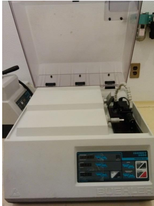
Figura 20. Cortadora ISOMET 2000 Precision Saw marca BUEHLER.
