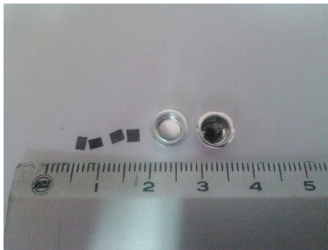
Figura 15. Portamuestras Perkin-Elmer y muestras de cintas metálicas.
