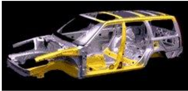
Figura 1.5. Chasis tipo monocasco.
