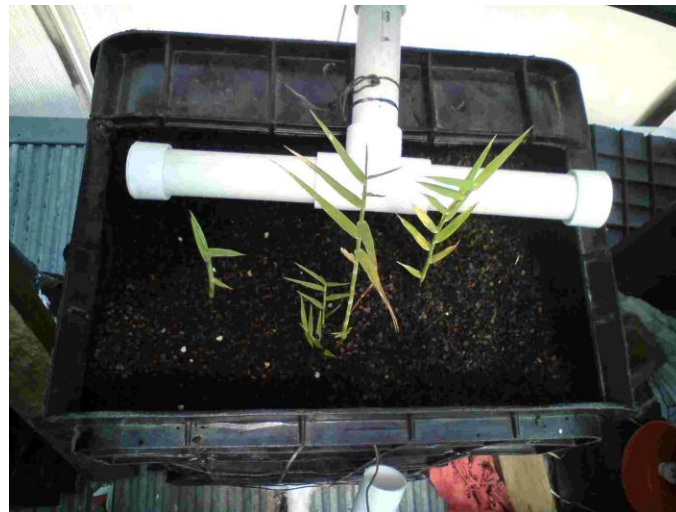
Figura 5. Sistema 3, de flujo vertical y con tres tipos de material de empaque (González González, 2011)
