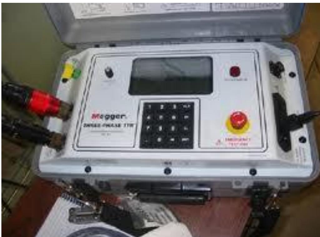
Figura: 1. 3. Equipo de prueba de la relación de espiras de transformadores (TTR)
