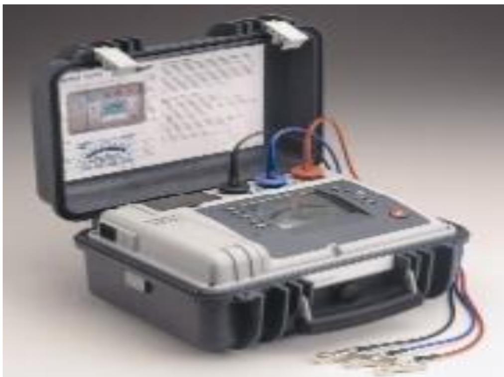
Figura: 1.1. Equipo resistencia de aislamiento
