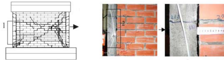
Figura 3.1 Falla a flexión de la mampostería confinada (Meli, Brzev et al. 2011)
