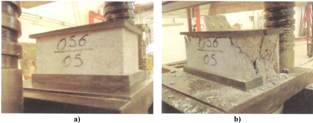
Figura 2.1 Ensayo a compresión axial de una pieza de concreto a) antes de aplicar la carga. b) modo de falla de la pieza, ( Industrial Bloquera Mexicana S.A DE C.V )
