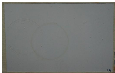
Figura 3.8 Recubrimiento expuesto en SO_2 durante 452hrs.
