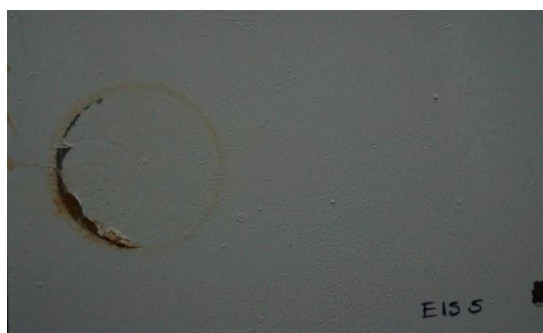
Figura 3.11 Muestra a 30 ciclos de evaluación con AC-DC-AC
