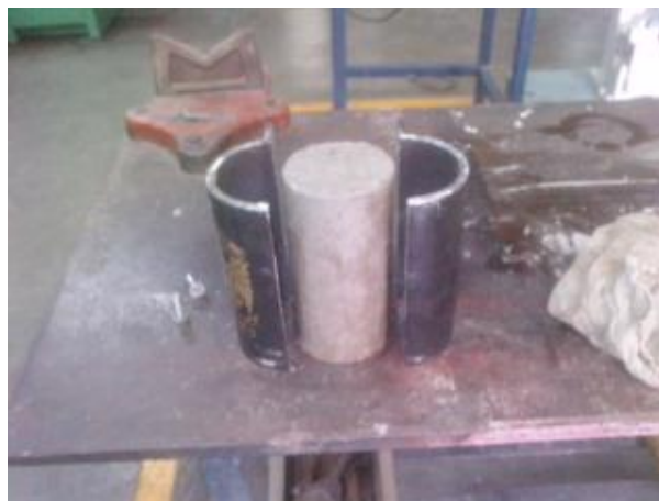
Figura 3.9 desmolde de probetas
