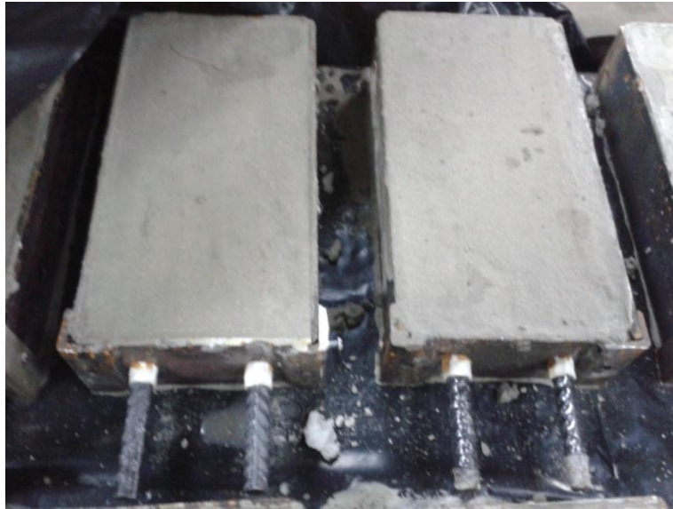
Figura 3.14B Llenado de moldes con el concreto.
