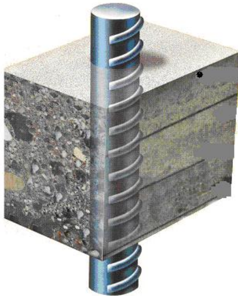
Figura 2.1. Componentes del concreto armado.
