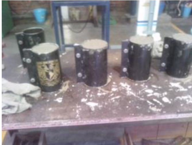
Figura 3.8 Vaciado de concreto al molde
