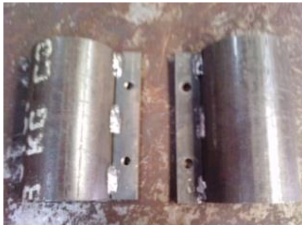
Figura 3.5 unión de elementos de sujeción del molde
