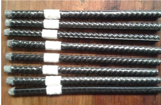
Figura 3.13 Varillas con recubrimiento de pintura epóxica más óxido laminar
