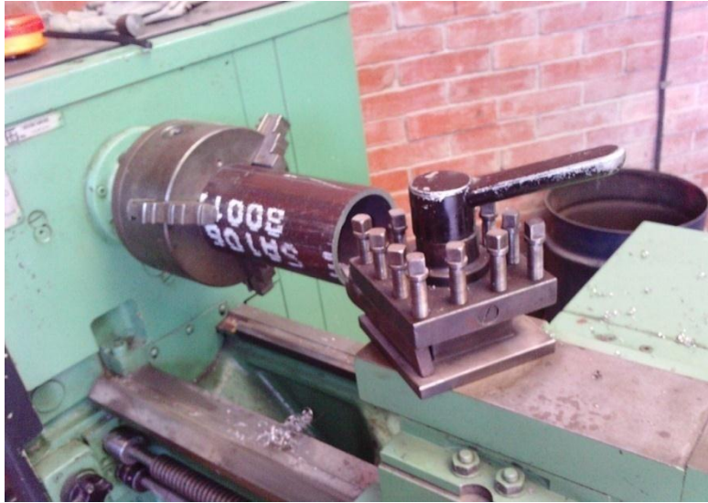
Figura 3.2 Refrentado de los cilindros
