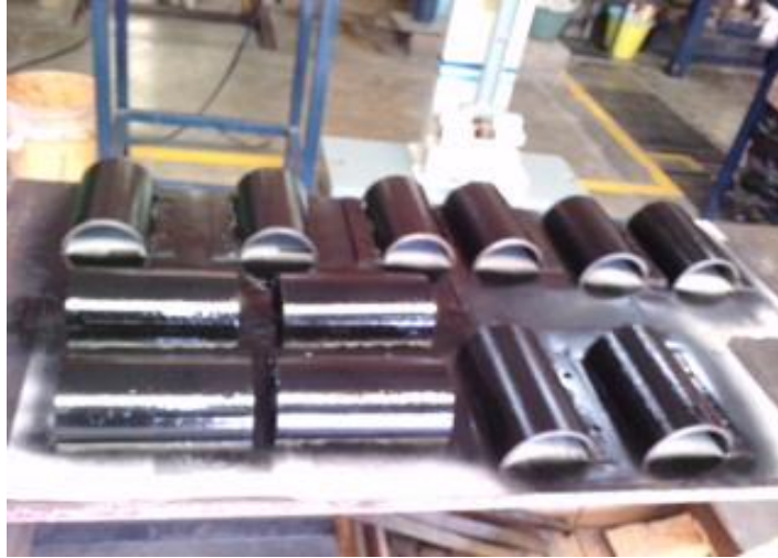
Figura 3.6 Aplicación de laca a los moldes
