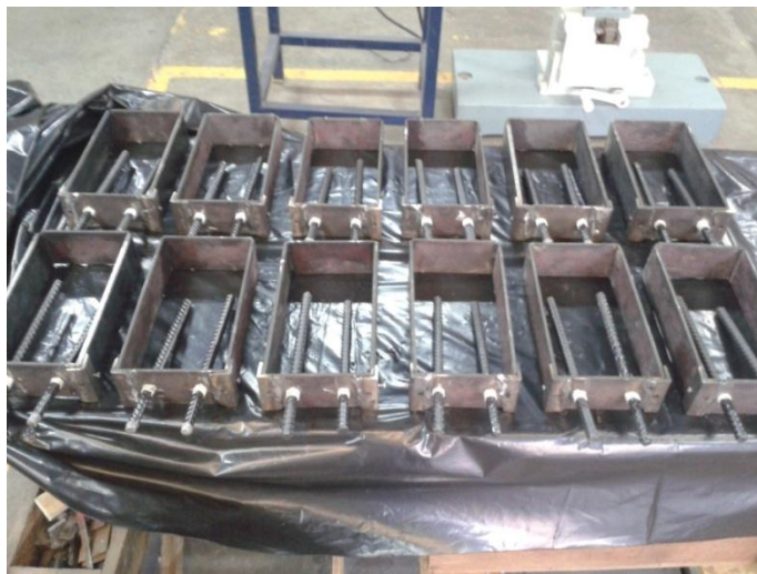
Figura 3.14A Colocación de la varilla dentro del molde
