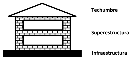
Imagen 1-2. Esquema de los principales componentes de una edificación.
