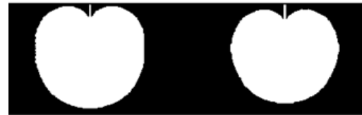
Imagen 1-10. Evolución de la optimización de forma de un objeto colgado en el aire bajo la acción de la gravedad. Solución ESO (Xie, Zuo, Huang, Tang, Zhao, & Felicetti, 2011).
