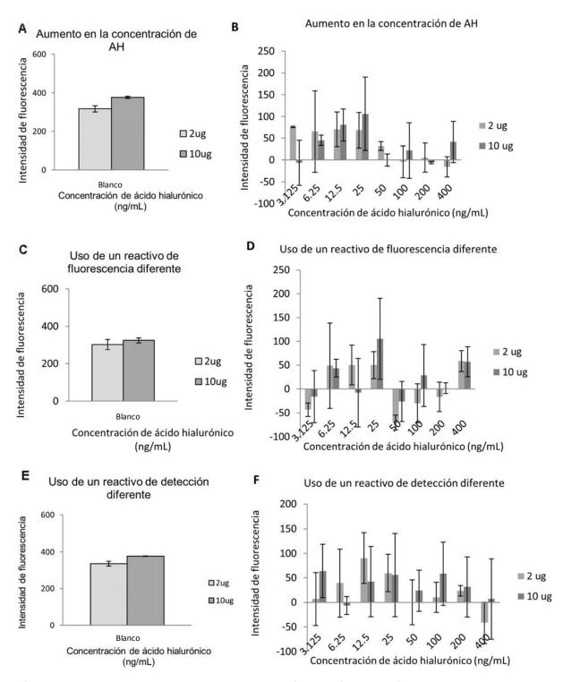
**Gráficas de las variaciones realizadas para las curvas estándar de ácido hialurónico.** Se observan las gráficas para las distintas variaciones realizadas. Figura A y B-Variación en las concentraciones de la curva de ácido hialurónico con aumento en la incubación, Figura C y D-Comparación entre reactivos de para el desarrollo de fluorescencia con aumento en la incubación, Figura E y F-Comparación entre lotes diferentes de estándares y reactivos de detección con aumento en la incubación.
