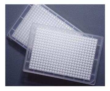
**Figura 8. Placa con filtro Millipore**®. Placa con 96 pozos. Cada pozo tiene un flitro Millipore® con poro de diámetro de 1.2 m, el cual impide el paso de la microesfera. Tomado de http://www.bioexpress.com/divinity-cart/item/350050/SEAHORSE-LABWARE-Filter-Plates/1.html
