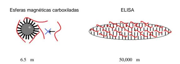
Figura 16. Comparación entre una esfera magnética acoplada a un anticuerpo y una acoplada a agrecano. Se observa que, debido al radio de la esfera magnética, la superficie de contacto para la unión del AH es menor que en la prueba ELISA, debido a que la unión de pocas moléculas de AH provocan un impedimento estérico responsable de los datos obtenidos en la validación con el estándar de AH.
