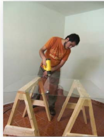
Ilustración 61 Deformado con pistola de calor
