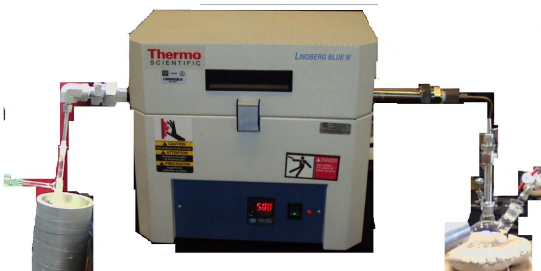
**Figura 3.2:** Equipo utilizado para el estudio de los conformeros de la 4-terbutilciclohexanona
