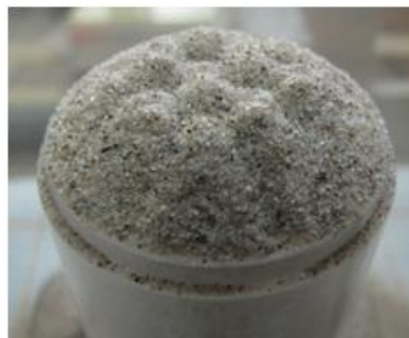
b. Pluviación con empleo de placa perforada.
