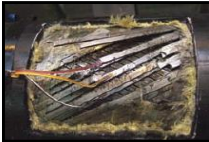
Figura 4.25 Presencia de corrosión en las líneas marinas. [Schlumberger]
