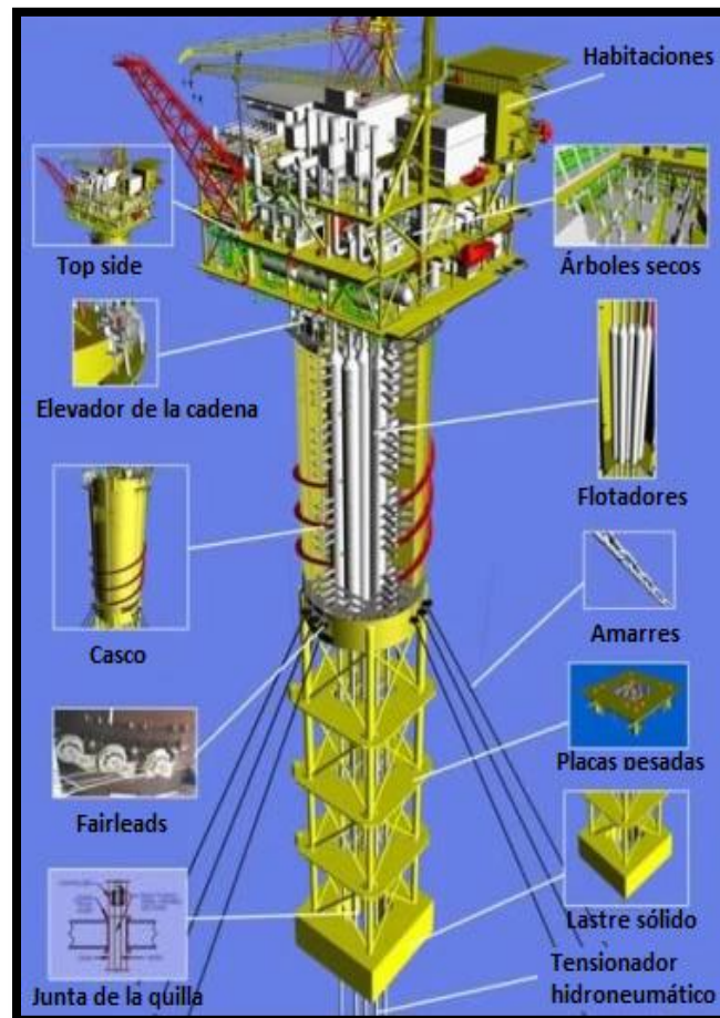
Figura 3.7 Principales componentes de una plataforma SPAR. [www.offshore-technology]
