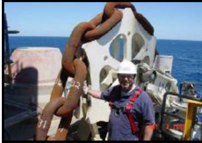
Figura 3.14 Cadena utilizada para anclar los sistemas flotantes. [16]
