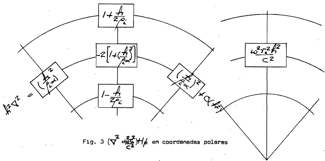
Fig. 3  $(\nabla^2 + \frac{\omega^2 r_0^2}{c^2}) H_0$  en coordenadas polares
