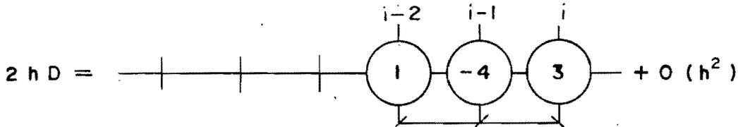
Fig. 5 Operador  $D = \frac{d}{dx}$  en diferencias hacia atrás
