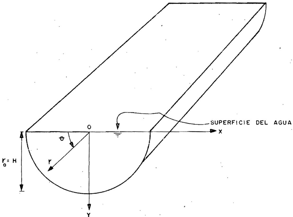
VASO CILINDRICO DE SECCION SEMICIRCULAR - LONGITUD INFINITA
