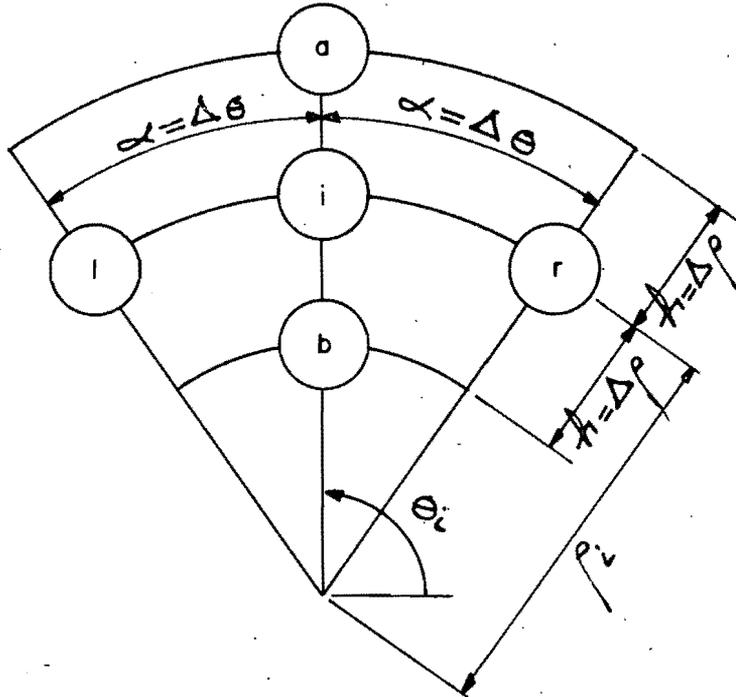
Fig. 4 Celosía en coordenadas polares
