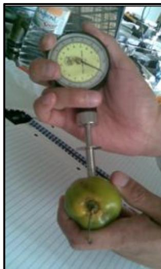
Figura 14. Penetrómetro manual Fruit Pressure Tester.
