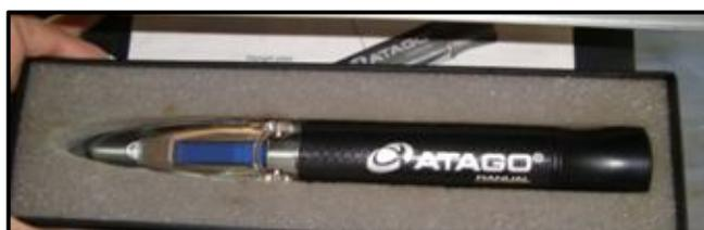
Figura 17. Refractómetro manual ATAGO.
