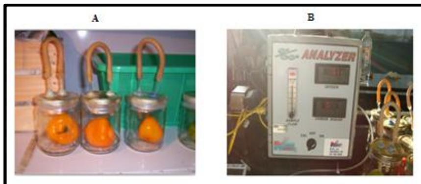
Figura 18. A) Chile manzano en envases cerrados, B) Analizador de gas por infrarrojo.
