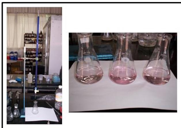
Figura 20. Valoración con indofenol del contenido de Vitamina C en chile manzano.
