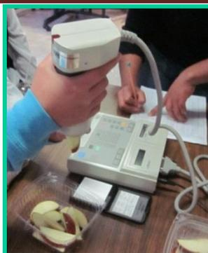
**Figura 19.** Colorímetro Minolta.
