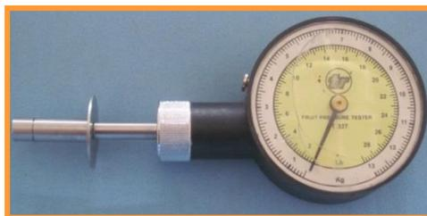
**Figura 16.** Penetrómetro manual.
