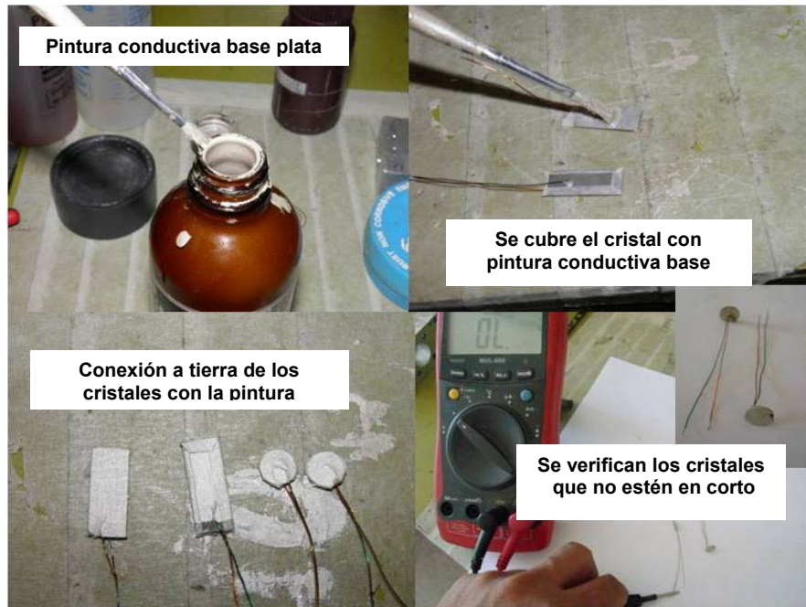
Figura 3. 16 Conexión a tierra de los cristales piezoeléctricos
