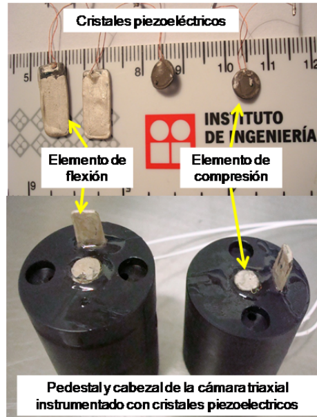
Figura 3. 9 Cabezal y pedestal de una cámara triaxial estática, instrumentada con los cristales piezoeléctricos.
