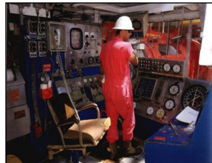
Fig.11 Medición de parámetros de perforación
