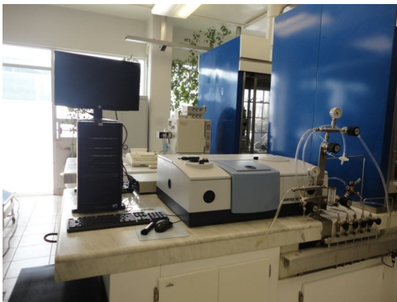
Figura 14 FT-IR Vertex 70 ubicado en el laboratorio de catálisis y energía de la BUAP.
