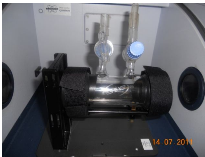
Figura 15. Celda de gases de espectrómetro FT-IR Vertex 70 ubicado en el laboratorio de catálisis y energía de la BUAP.
