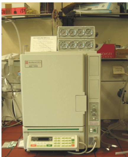
Figura 13. Cromatografo de gases marca Shimadzu GC-14B ubicado en el Laboratorio de catálisis y energía de la BUAP.
