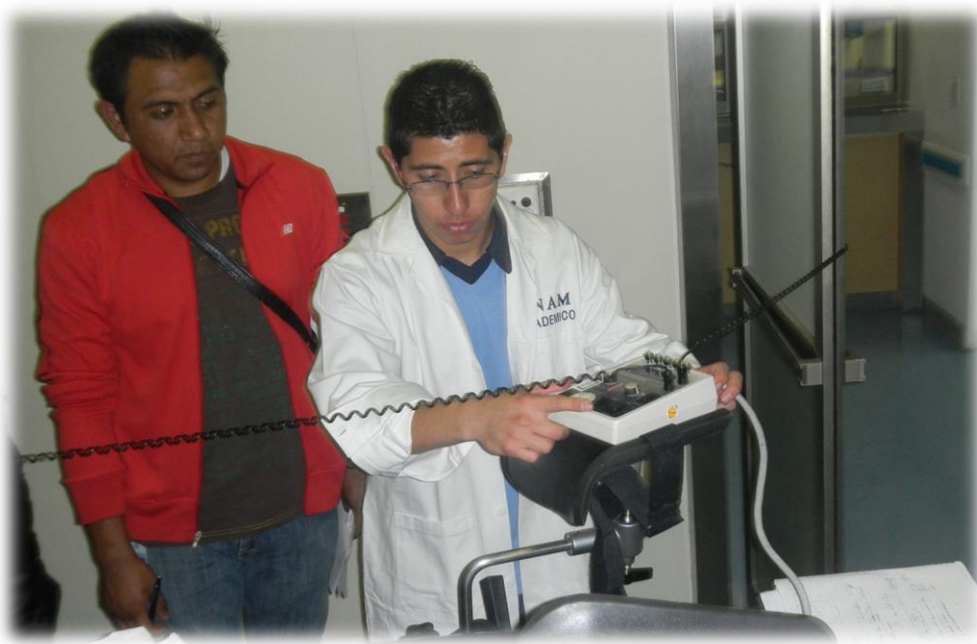
Figura 34. Modo de empleo del Electrical Safety Analyzer para la ejecución de la prueba 4.
