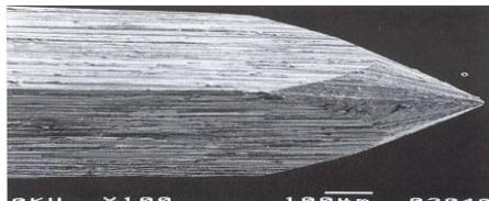
Fig. 9. microfotografía de la punta del asta antes del proceso de torsión.
