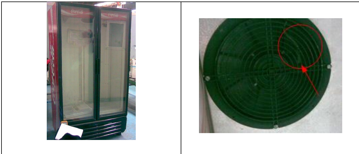
Figura 5.2. Colocación de termistor en el ventilador del interior del enfriador para el sensado de temperatura
