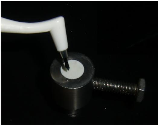
Fig.12. Aplicación del adhesivo con un pincel que proporciona el fabricante. fd
