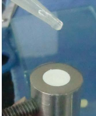
6.- En el grupo 2 (10 muestras) se le aplicó ácido orto fosfórico al 37 % durante 30 segundos ( Fig.11) y después se lavó con agua durante 15 segundos.
