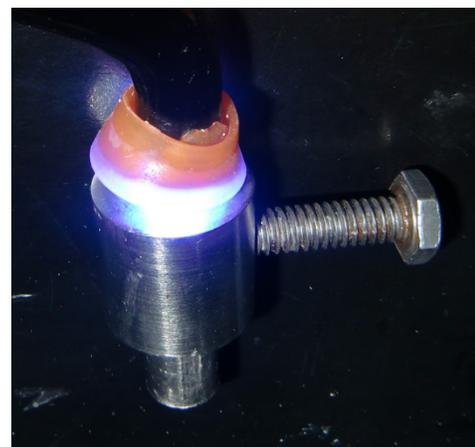
12.- Después de polimerizar la resina la muestra se sometió a la prueba para la determinación de fuerza de adhesión hasta lograr el desprendimiento del cilindro de resina usando la máquina universal de pruebas mecánicas INSTRON 5567 con una velocidad de aplicación de fuerza de 1 mm/min. (Fig.17-18).
