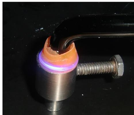
10.-En un molde para preparar muestras de resina de 5 mm de diámetro por 2 mm de altura (Fig.14), se coloca resina sobre la superficie de adhesivo para rellenarse en una sola intención con instrumentos de teflón (Fig.15).
