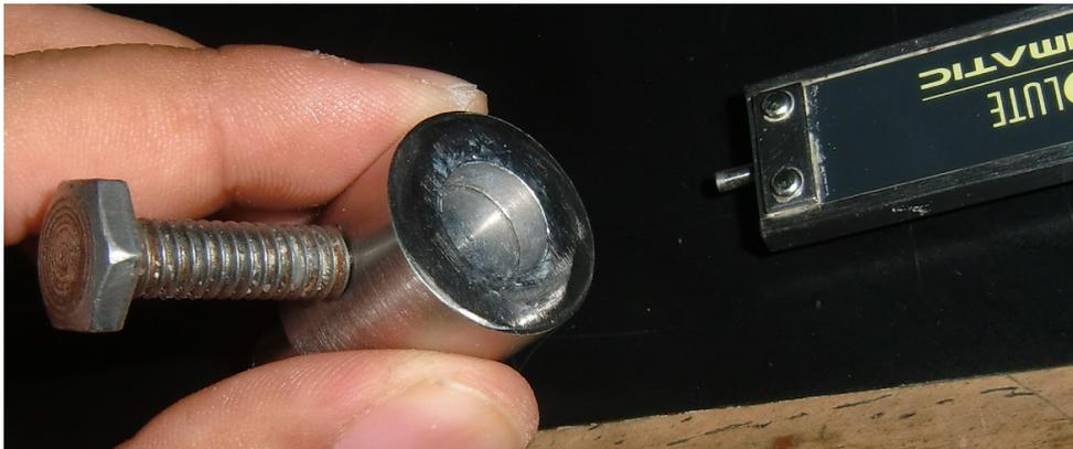
Fig. 7. Imagen mostrando el ajuste de la profundidad del molde por medio de un Vernier electrónico. fd
