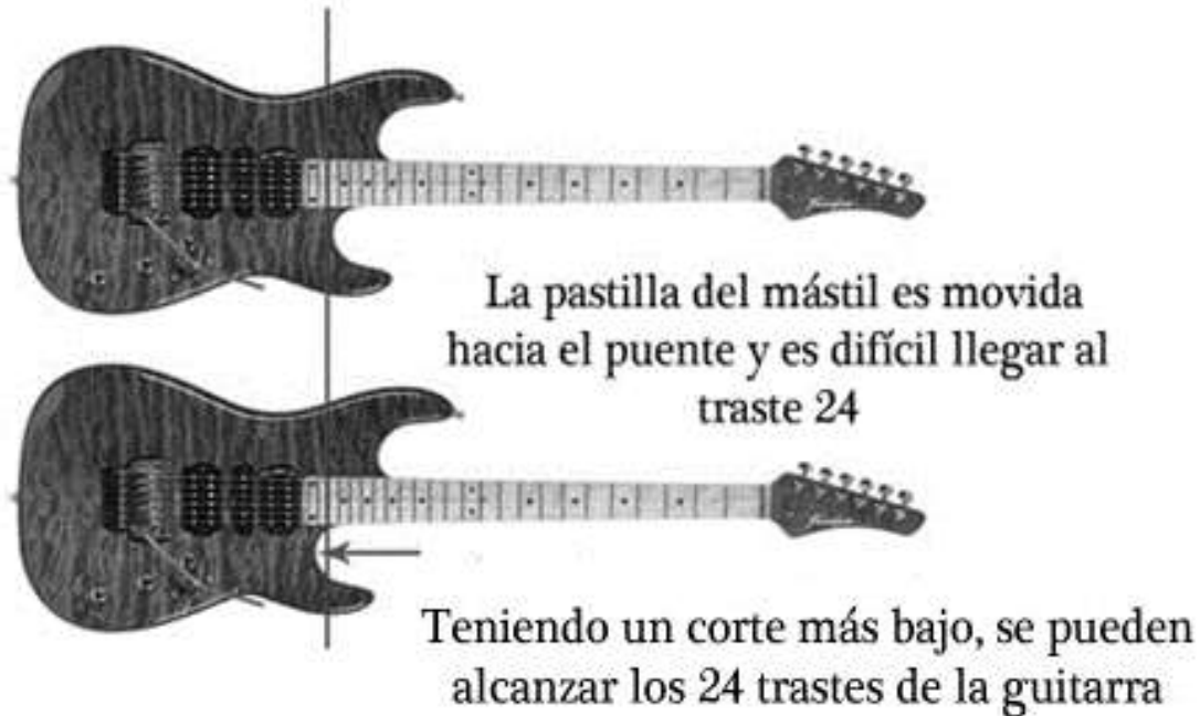
Fig. 6.27 Esquema que muestra los cambios que se deben hacer al tener una guitarra de 24 trastes 38
