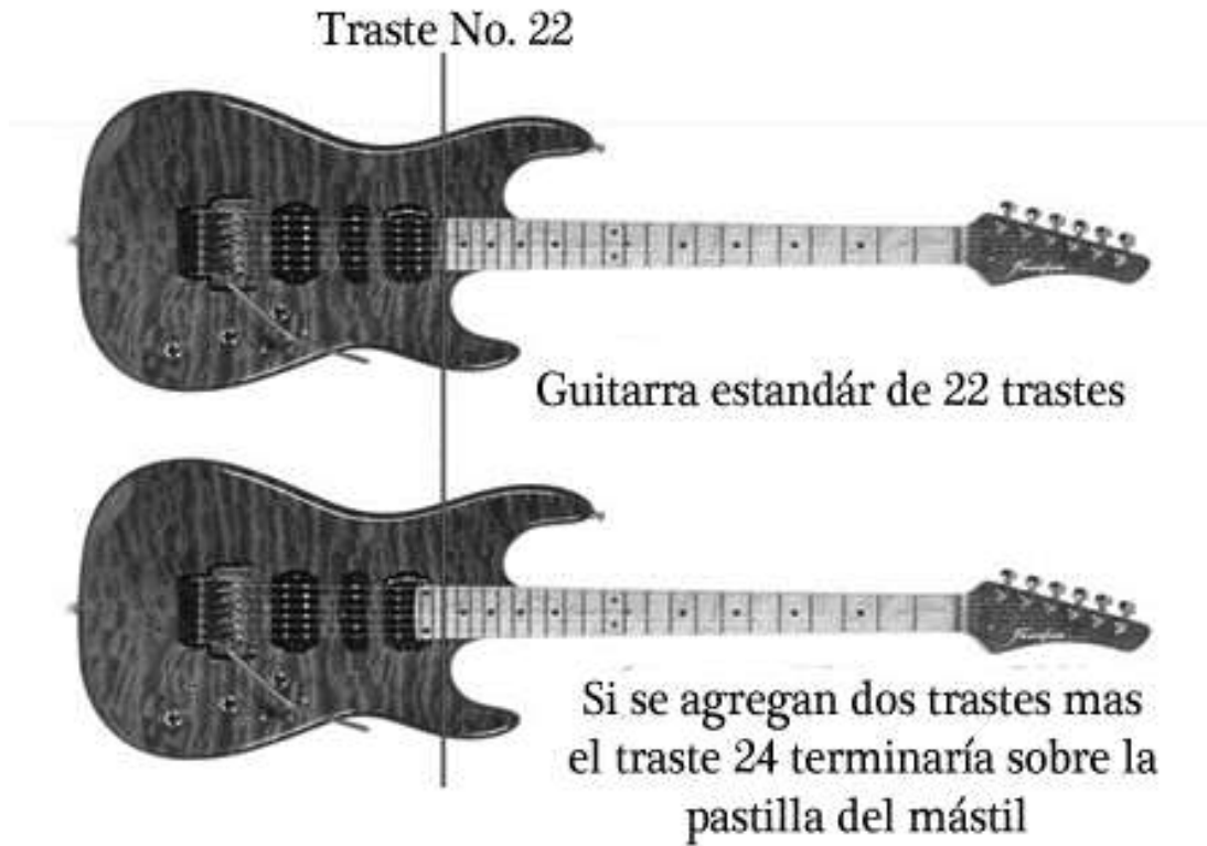
Fig. 6.26 Comparación entre una guitarra de veintidós trastes y otra de veinticuatro
