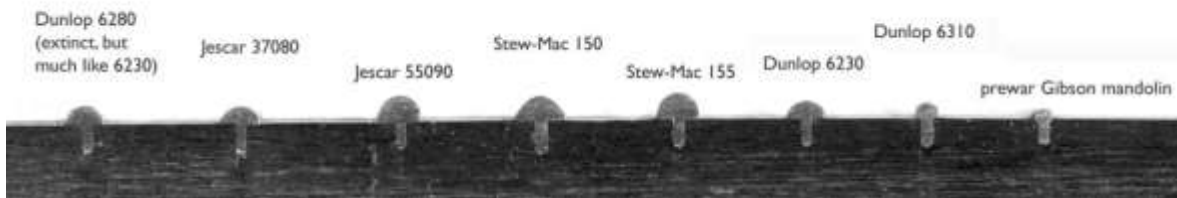
Fig. 6.17 Ejemplos de altura en trastes de guitarra 32
