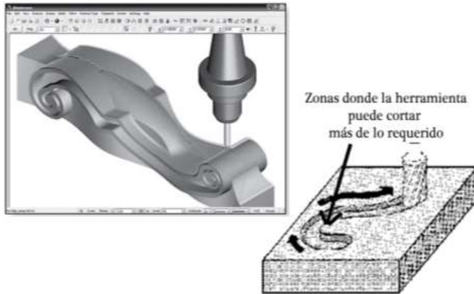
Fig. 4.4 Manufactura de pieza con curvas y formas irregulares; el número y tamaño de curvas cóncavas tendrá repercusión en la factibilidad de la manufactura, la adecuada selección de herramientas; evitará errores y acabados no deseados en la manufactura de este tipo de piezas
