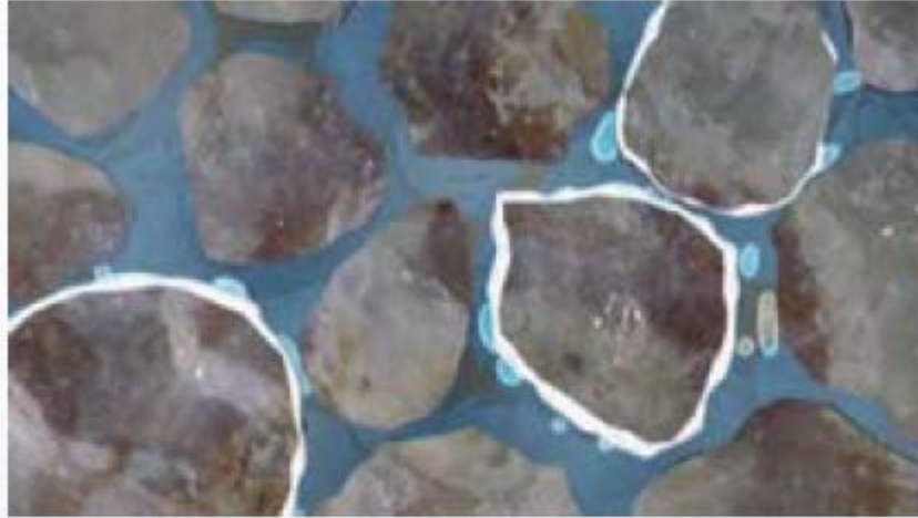
Figura 2.23 El CO 2 denso migrando hacia arriba (burbujas azul claro) disolviéndose y reaccionando con los granos de la roca, lo cual lleva a la precipitación de minerales carbonatados en los bordes de los granos (color blanco) ( www.co2geonet.eu ).
