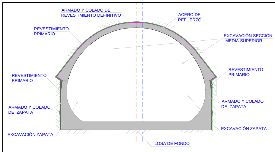
Figura No. 45 Sección de túnel terminada
