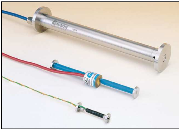
Figura No. 12 Deformímetro de concreto
