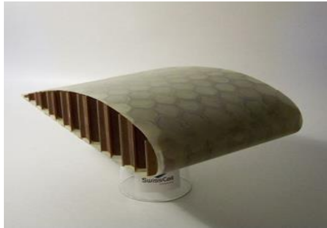
Fig. 41. Estructura tipo Panal de Abeja.
