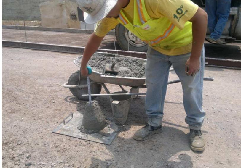
Imagen 14.- Revisión de revenimiento del concreto puesto en obra
