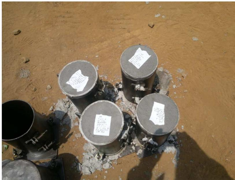
Imagen 15.- Extracción de muestras de concreto para verificar el grado de resistencia
