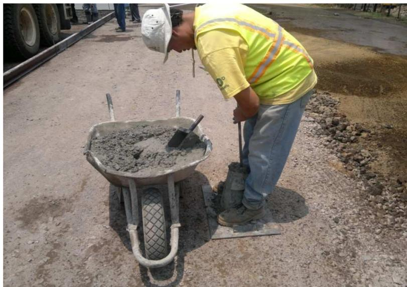
Imagen 13.- Extracción de concreto puesto en obra, para realizar prueba de revenimiento.
