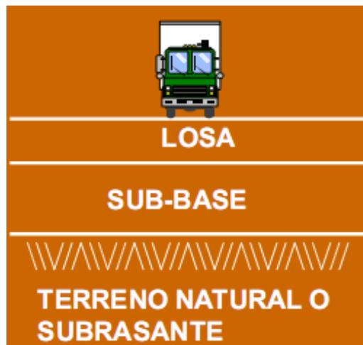
Imagen 2.4.- Estructura del pavimento rígido.
