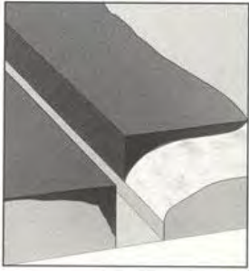
Imagen: 2.14 Juntas de construcción
