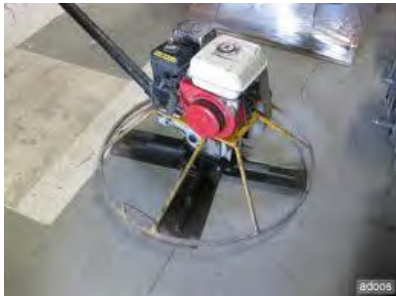
Imagen: 2.12 Helicóptero utilizado para alisar y compactar el concreto.
