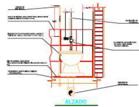
DETALLE SANITARIO DE WC PARA DISCAPACITADOS ESQ. 1:10 ALZADO
