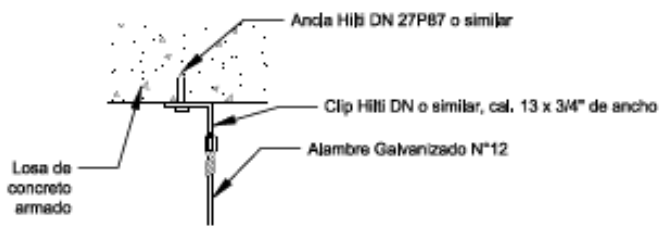
DETALLE DE FIJACIÓN VERTICAL DE COLGANTE
