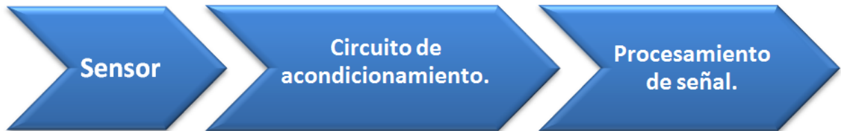
Figura 5.3: Manejo de señales eléctricas.
