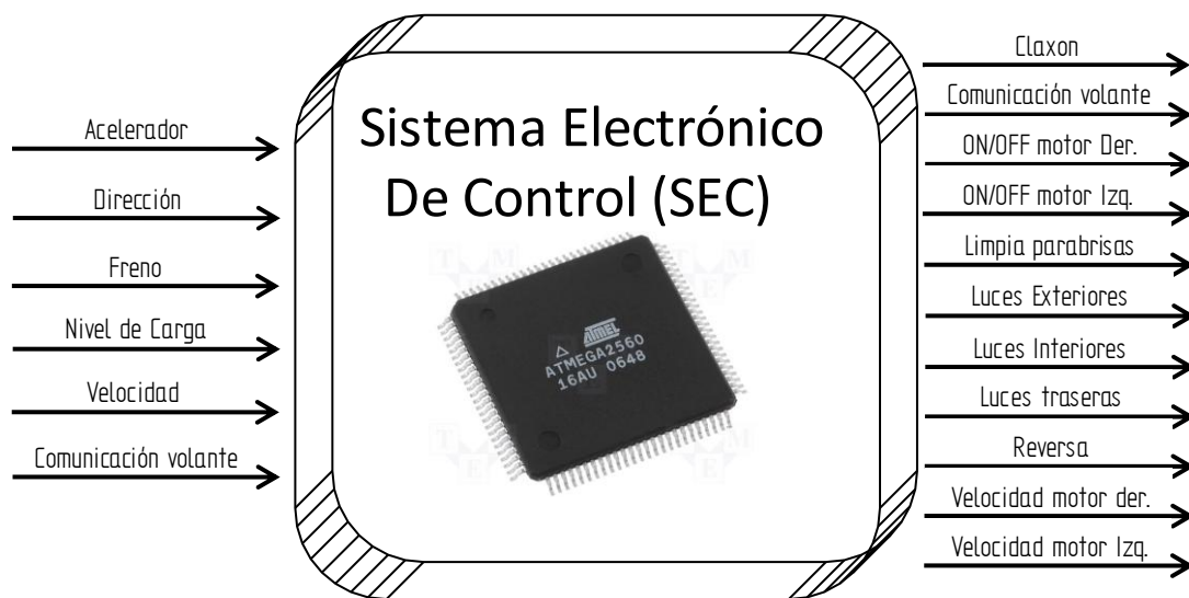
Figura 5.1: Diagrama de entradas y salidas.
