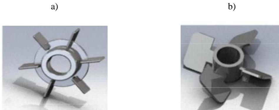
**Figura 10.-** Impulsores a) turbina plana de Rushton y b) turbina de Maxflo.
