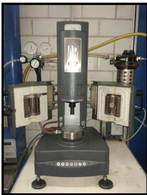
**Figura 12.-** AR-G2 reómetro de deformación controlada TA instruments.
